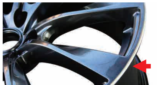
アクセントとしてリムエッジを凹に切削し、光沢のあるヘアライン+クリア仕上げ
